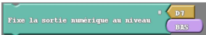
Arrête l'actionneur branché sur le port D7
