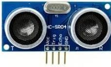
Capteur de distance ultrason
