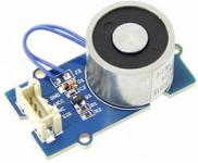
**Attention** : L'électroaimant est un actionneur, mais il est commandé par l'intermédiaire du Relais. On dit que le relais est un pré-actionneur. C'est donc bien au relais que tu enverras des ordres, et pas à l'électroaimant.
