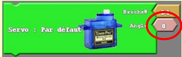
Le servomoteur est commandé en position en spécifiant un angle compris entre 0° et 170°.
