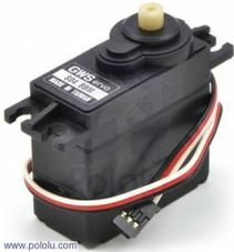
Pour propulser le moteur, nous allons utiliser deux servomoteurs à rotation continue. Ces éléments développent un fort couple et peuvent tourner dans les deux sens à une vitesse choisie par le programmeur.
