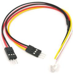
Les deux servomoteurs se branchent sur la carte Arduino par l'intermédiaire d'un unique câble spécifique.
