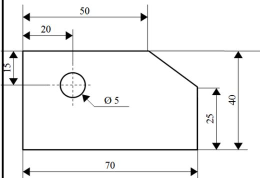
Pour chacune des pièces de ton robot que tu devras fabriquer, tu réaliseras au préalable un dessin de définition, c'est-à-dire un dessin à l'échelle comportant toutes les cotes (dimensions) nécessaires à sa fabrication.
