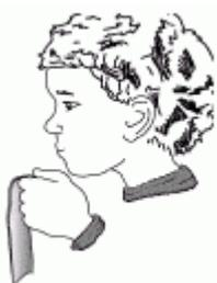
4 - Tiens avec tes deux mains une feuille de papier et place la devant ta bouche en la laissant pendre comme montré sur la figure de gauche. Souffle sur le dessus de la feuille. Que se passe-t-il ?
