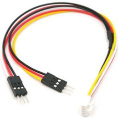
Les servomoteurs se branchent sur la carte Arduino par l'intermédiaire d'un câble spécifique.
