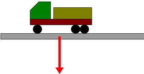
Le poids des véhicules qui passent sur un pont exerce une contrainte sur ce dernier. On peut la représenter par une flèche.
